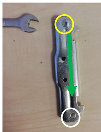
**ATTACH THE HINGE THAT IS REMOVED FROM THE RIGHT SIDE TO THE LEFT SIDE**
